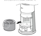
**4** 關閉蓋子前,請插入蓋子底部兩端的固定零件至產品底部的孔洞。
